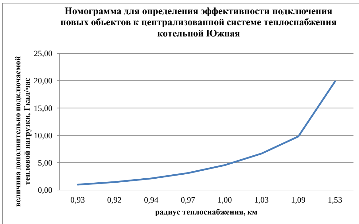
Рисунок 2.5 – Номограмма для определения эффективности подключения новых объектов к централизованной системе теплоснабжения котельной «Южная»
