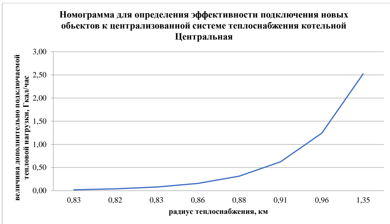
Рисунок 2.4 – Номограмма для определения эффективности подключения новых объектов к централизованной системе теплоснабжения котельной «Центральная»
