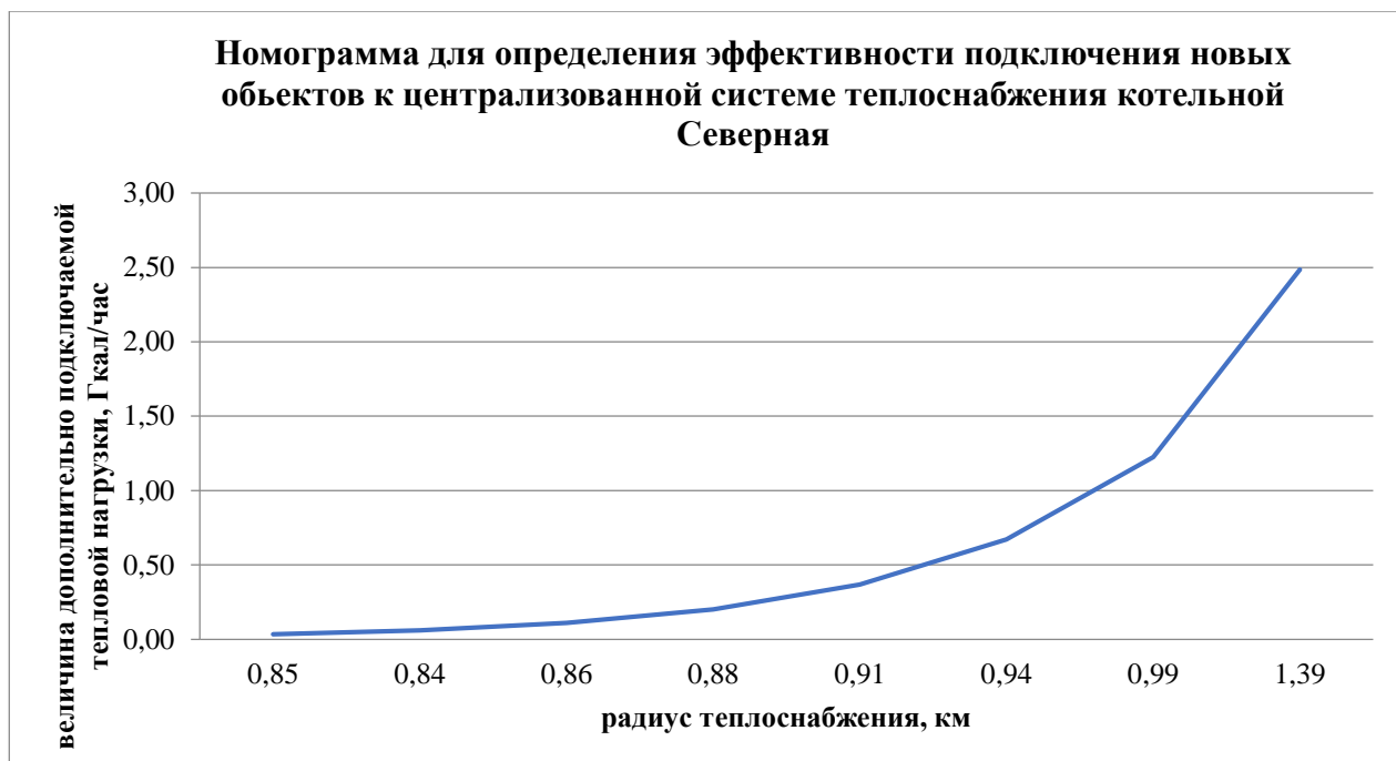
Рисунок 2.3 – Номограмма для определения эффективности подключения новых объектов к централизованной системе теплоснабжения котельной «Северная»
