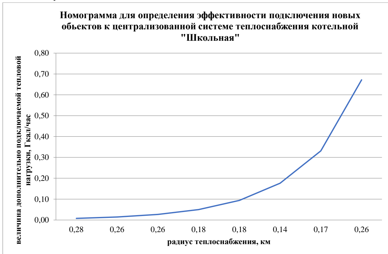
Рисунок 2.1 – Номограмма для определения эффективности подключения новых объектов к централизованной системе теплоснабжения от котельной «Школьная» МО Город Венев
