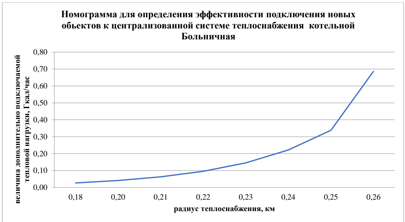
Рисунок 2.2 – Номограмма для определения эффективности подключения новых объектов к централизованной системе теплоснабжения котельной «Больничная»
